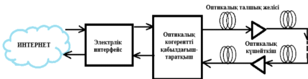
1.7-сурет – Нүктеден нүктеге оптикалық талшықты жүйенің типтік конфигурациясы
